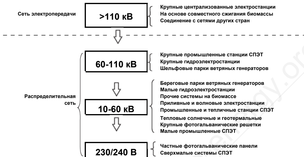
Рисунок 7. Схема структуры типовой европейской электросети и уровни подключения систем ДГ и ВИЭ. Значения напряжений в разных странах могут отличаться.
